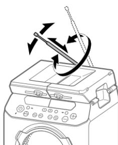
Mở rộng anten FM và chỉnh độ dài vào góc để nhận tín hiệu tốt nhất. Hãy xem phần "Điều khiển anten FM" (trang 31).
