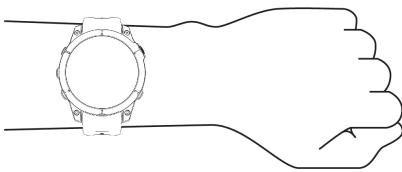
**LƯU Ý:** Cảm biến quang được đặt ở mặt sau thiết bị.
