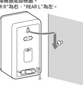
準備適合牆壁材料和強度的螺絲(無附帶)。由於石膏 板牆壁易碎,請將螺絲牢固釘入牆柱。將揚聲器安裝在 加固的牆壁上,確保左右揚聲器的高度相等。
