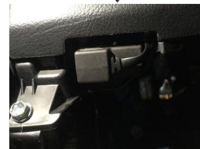
Bước 5: Kết nối nguồn và cổng OBDII
