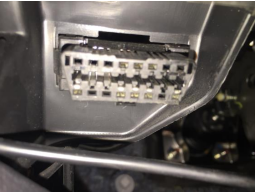
Cách 1: Kiểm tra cổng kết nối OBDII phía dưới tay lái
