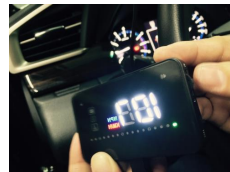
Điều chỉnh độ lệch tốc độ hiển thị trên HUD và tốc độ xe
