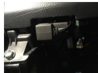
Bước 5: Kết nối nguồn và cổng OBDII
