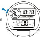
2. Bấm "D" để tăng giờ, bấm và giữ để tăng với tốc độ nhanh hơn
